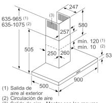
(3) Salida de aire - Montar con las ranuras de la salida de aire al exterior hacia abajo Dimensiones en mm
