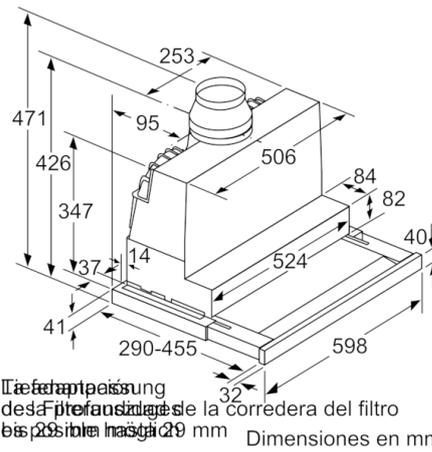
La altura de la tapa de la aspiración desde el fondo de la corredera del filtro es de 29 mm hasta 49 mm. Dimensiones en mm
